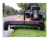
Die über gesamte Breite gehende Walze schützt die Schlegel vor Beschädigungen und ermöglicht so das Mähen auch an höheren Kanten.
