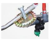
Flexible Kupplungen schützen den Spritzbaum und ermöglichen einen einfachen Transport, wenn das Spritzgerät nicht genutzt wird.
