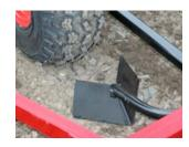
Der Wheel Levelling Kit ist als Option erhältlich um den Boden in einem Arbeitsgang zu glätten.
