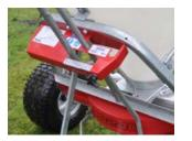
Die einstellbare Streuflusskontrolle kann einfach vom ATV-Fahrersitz bedient werden. Der Antrieb der Streuscheibe kann jederzeit während der Fahrt gelöst werden.
