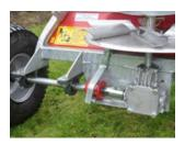
Da es an diesem Streugerät nur wenige sich bewegende Teile gibt, ist der Wartungsaufwand minimal. Die hochwertige galvanische Bearbeitung der Metallteile sorgt dafür, dass Sie das Streugerät lange Jahre nutzen können.
